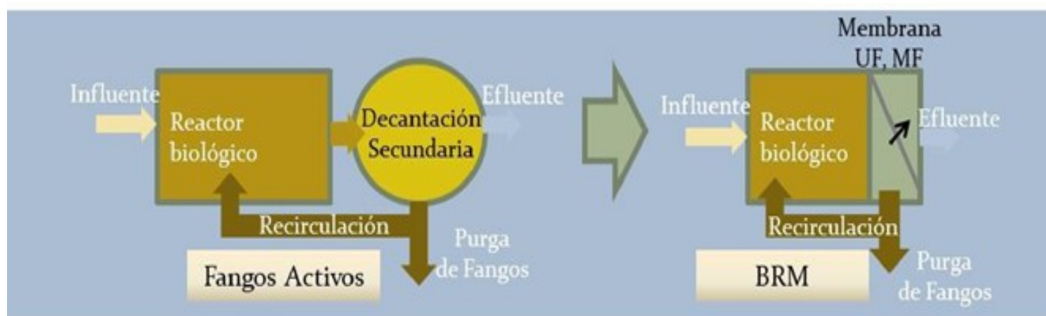
Figura 1. Evolución del proceso de fangos activos a biorreactor de membrana
